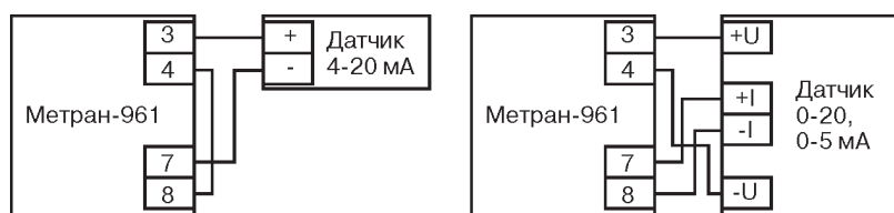
Рис.5. Подключение датчиков по 2-х-проводной (5а) и 4-х-проводной (5б) схемам.
