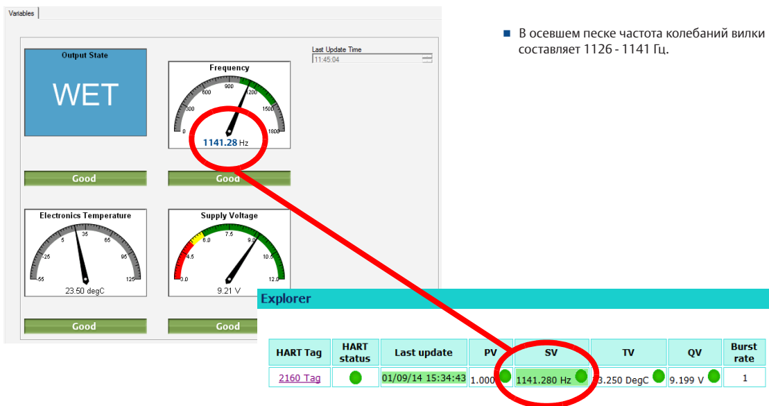
Рисунок 3-5. «Мокрое» состояние сигнализатора Rosemount 2160 в осевшем песке или отложениях
