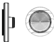
Сборка с одной разделительной мембраной Rosemount 1199 (код модели S1)
