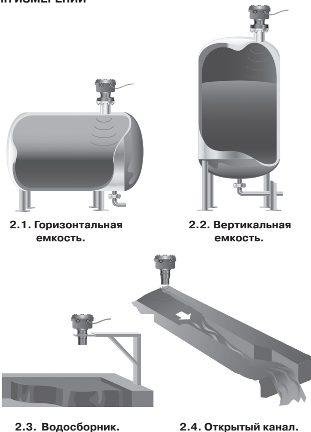
Рис. 2. Примеры установки уровнемеров 3100.
